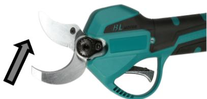
4. Rimuovere il bullone esagonale vicino alle lame di taglio con la chiave esagonale ruotandolo in senso antiorario. Rimuovere il dado di serraggio delle lame vicino alle lame di taglio con una chiave adatta o simili ruotandolo in senso antiorario ed estrarre la rondella.
