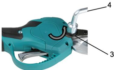
5. Rimuovere i due bulloni vicino alle lame di taglio con la chiave esagonale ruotandoli in senso antiorario. Rimuovere il coperchio della testa separando la linguetta sul coperchio della testa dalla scanalatura dell'alloggiamento. Estrarre il gruppo lama di taglio superiore.
