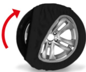
**3** Spostare l'auto quanto basta per completare la copertura pneumatico con la calza.
