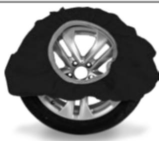
**1** Per un'installazione rapida e semplice, applicare le calze neve sulla parte superiore del pneumatico.
