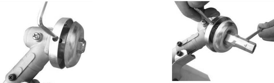
5.2. **Montaggio della testina in nylon.** Rimuovere un'altra protezione dopo aver tolto i bulloni, come mostrato nell'immagine. Tenere fissa la flangia, mettere la testina in nylon sull'asta e girare in senso antiorario, fissando la testina.
