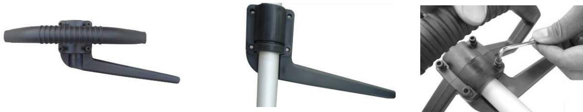
4. Montare il dispositivo di protezione. Allentare le viti esagonali posizionate sulla base fissa del dispositivo di protezione, poi allentare il piano fisso come nell'immagine sottostante e alla fine fissare il dispositivo di protezione con la chiave a brugola e quella normale, fornite come accessori standard per l'avvitamento corretto dei bulloni.
