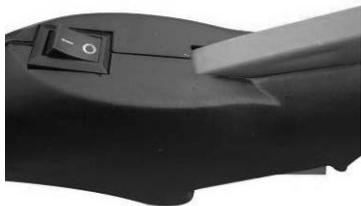
9. Se la macchina è calda, la leva dell'acceleratore può essere regolata nella posizione ON all'avviamento della macchina.
