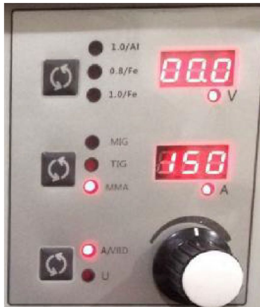
Figura 11: metodo di saldatura MMA con VRD (il LED 'A/VRD' è acceso)
