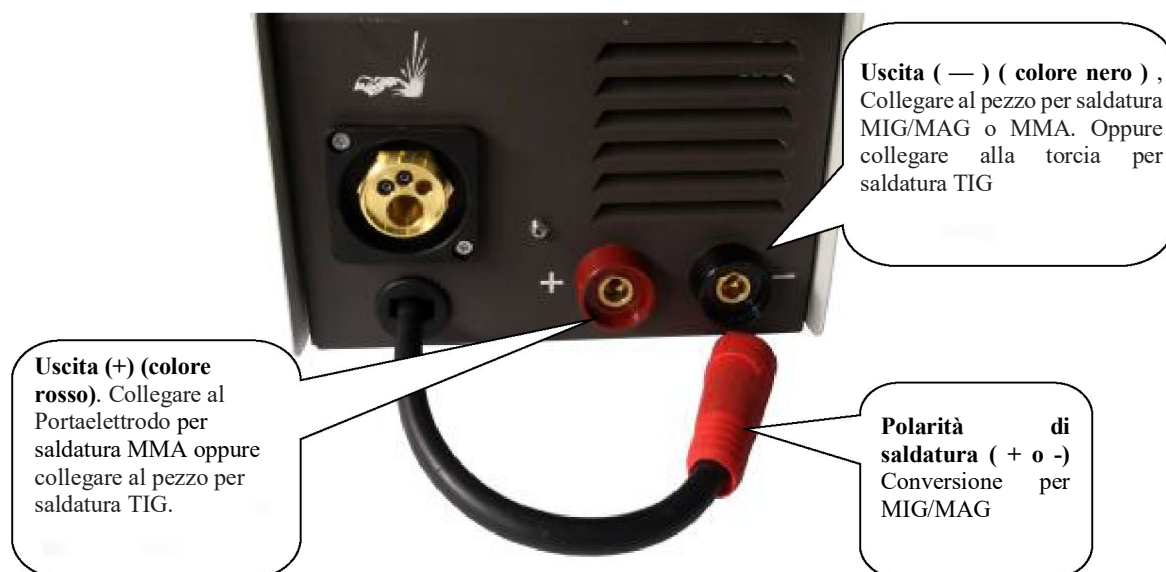
Figura 3: pannello anteriore della sorgente di alimentazione della saldatura
