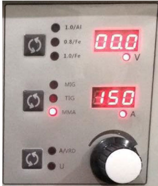
Figura 10: metodo di saldatura MMA senza VRD (il LED 'A/VRD' non è acceso)
