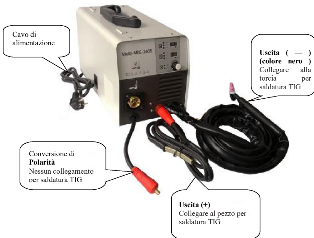
Figura 8: collegamento per metodo di saldatura TIG
