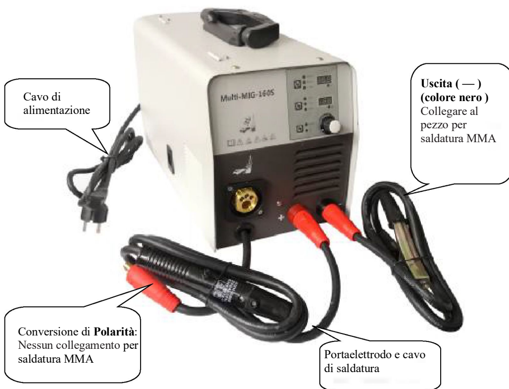
Figura 7: collegamento per metodo di saldatura MMA
