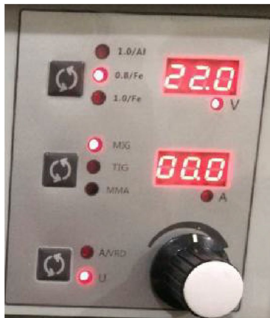
Figura 14: quando il LED 'U' è acceso e lampeggiante, impostare la tensione di saldatura (V) per il metodo di saldatura MIG/MAG.
