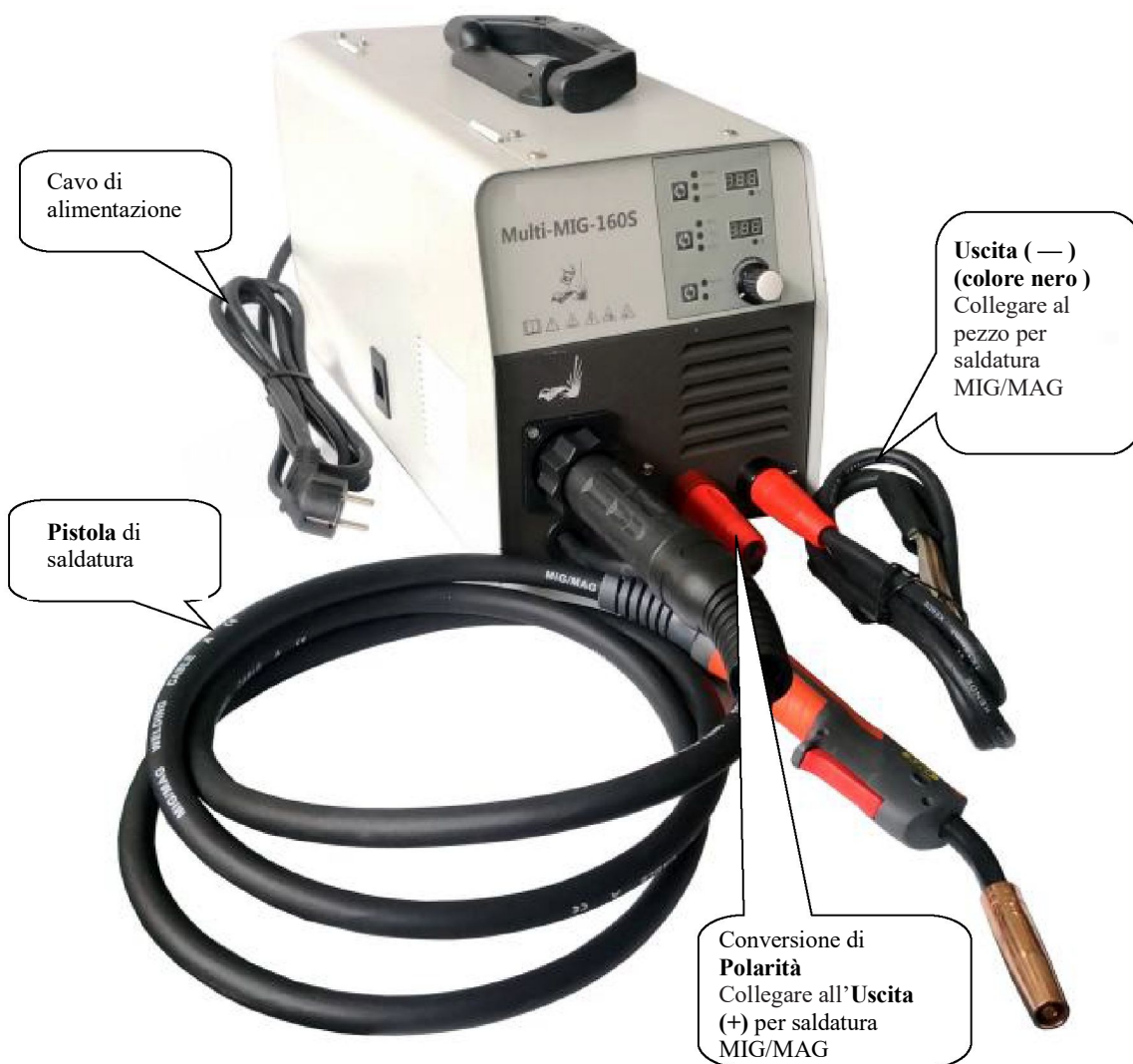
Figura 6: collegamento per metodo di saldatura MIG/MAG
