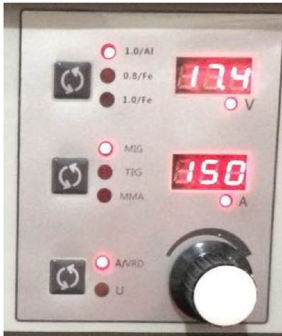
Figura 13: quando il LED 'A/VRD' è acceso e lampeggiante, oppure il LED 'A/VRD' non è acceso, impostare la corrente di saldatura (A) per il metodo di saldatura MIG/MAG
