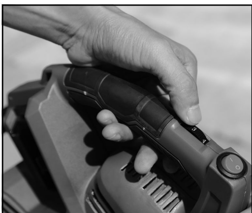
Interruptor en posición de apagado
