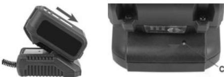
Dare inizio al caricamento inserendo la batteria nella fessura del caricabatteria quindi inserendo la spina del caricabatteria nella presa di corrente. L'indicatore di carica (C) lampeggerà in rosso durante il caricamento. La batteria e il caricabatteria raggiungono una temperatura elevata durante il processo.
