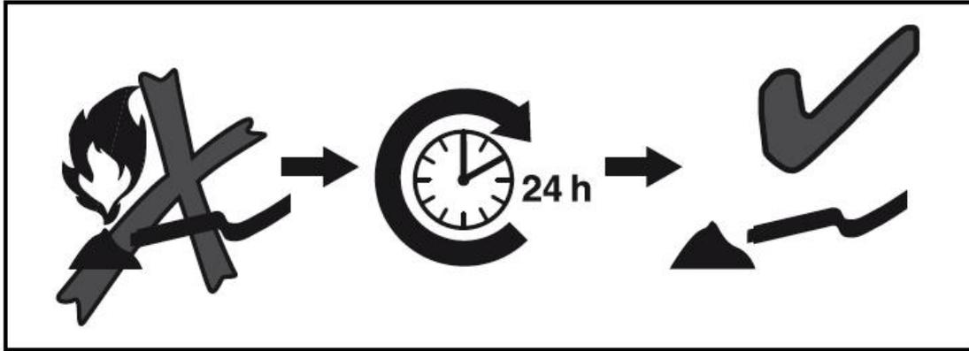
Espere por lo menos 24 horas antes de aspirar un horno o una chimenea con el fin de asegurarse de que el fuego se haya apagado y la ceniza se haya enfriado. ¡Sólo para ceniza fría, consulte las instrucciones de uso!
